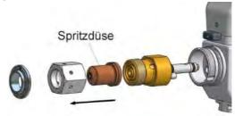
4. Düsenträger in einen Schraubstock einspannen. Überwurfmutter mit Rechtsdrehung festschrauben. Kontermutter mit Gegendrehen festziehen. Danach den Düsenträger mit Spritzdüse einsetzen.
