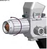
2. Düsenträger aus dem Gehäuse nehmen und in einem Schraubstock einspannen. Kontermutter mit Schraubenschlüssel und Gegendrehung festhalten. Überwurfmutter mit Linksdrehung entfernen.
