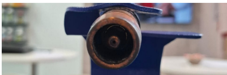
Brenner geschützt mit RESTAK® nach 6-8 Stunden Gebrauch
