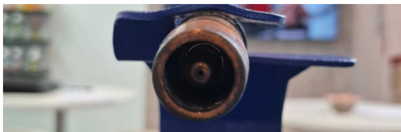
Brenner geschützt mit RESTAK® nach 6–8 Stunden Gebrauch
