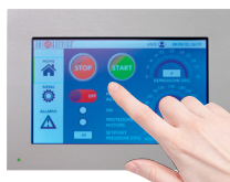
Controllo digitale a PLC
