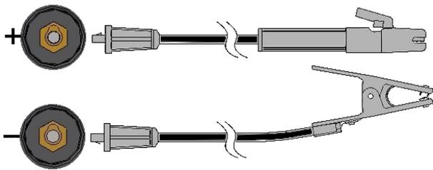
Connectez le câble électrode à la borne (+) et la pince de masse à la borne (-). Insérez la prise dans la borne en tournant un ¼ de tour dans le sens des aiguilles d'une montre. Ne serrez pas plus.
