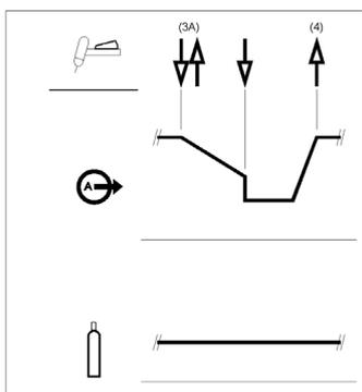
Lorsque la gâchette de la torche TIG est relâchée, la sortie augmente à nouveau jusqu'au courant de soudage, comme à l'étape 4, pour continuer le soudage. Lorsque la partie principale de la soudure est terminée, passer à l'étape 3.
