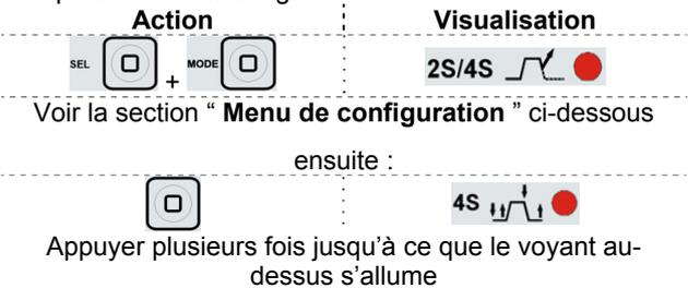
Si le redémarrage 4 temps est activé dans le menu de configuration, la séquence suivante se produit pour les étapes 3 et 4 (les étapes 1 et 2 ne sont pas affectées par l'option redémarrage) :
