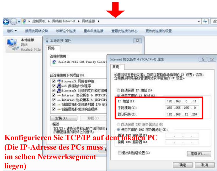
Abbildung 6 Schritte der Ethernet-Verbindung
