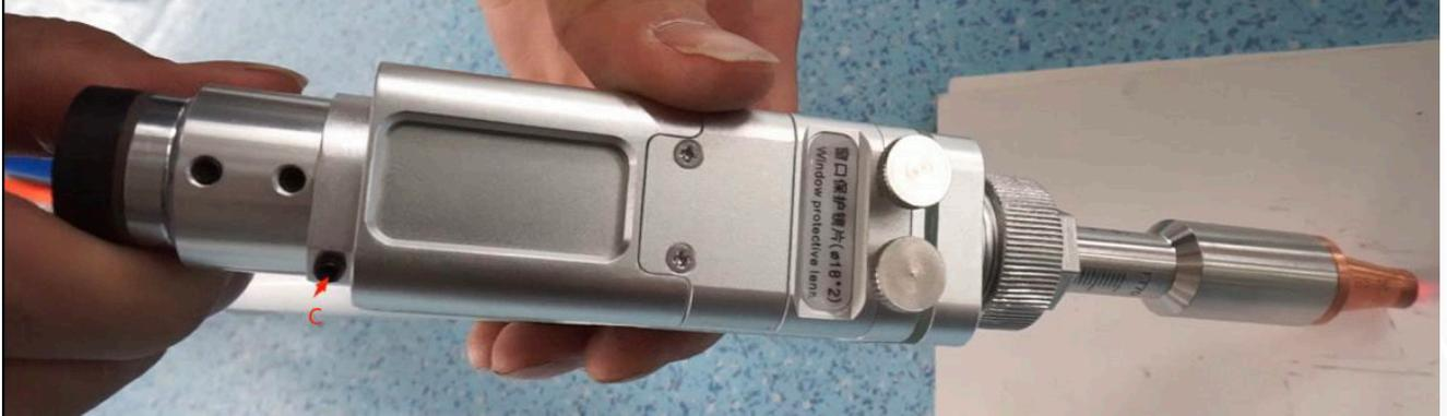
4. Einstellung durch Schrauben A und B (oben und unten vorhanden).
