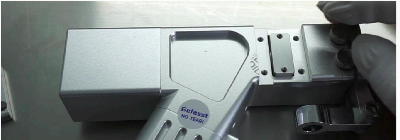
**4. Platinenkarte:** Zur Überprüfung, ob die Sicherungsschraube der Platinenkarte locker ist oder abfällt (siehe Bild).
