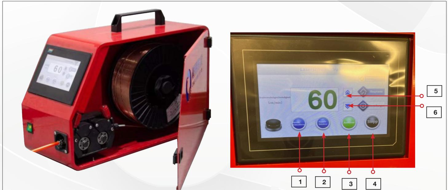
Das gesamte Drahtzuführsystem besteht aus dem Drahtzuführungssystem, dem Drahtzuführschlauch und dem Drahtzuführzentrum. Es kann Aluminiumdraht, Kohlenstoffstahldraht, Edelstahlschweißdraht usw. senden.
