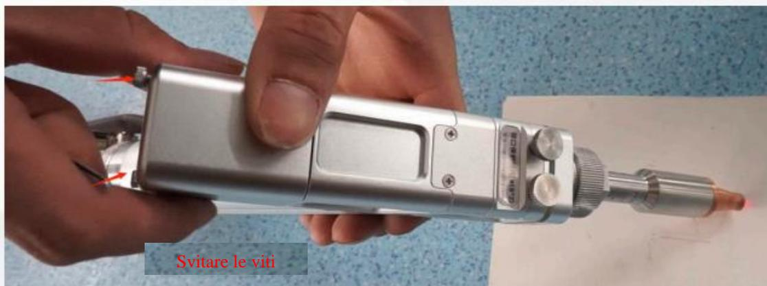
3. la vis C ne doit pas être desserrée, sinon le moteur sera réglé.
