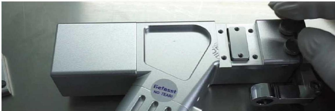
**4. Carte de circuit imprimé:** Pour vérifier si la vis de blocage de la carte de circuit imprimé est desserrée ou tombée (voir photo).
