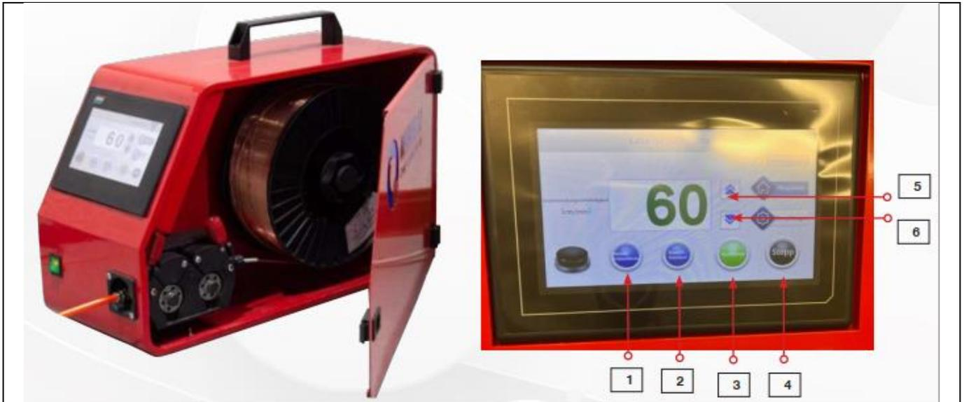
Il sistema di alimentazione del filo nel suo insieme è formato dal sistema stesso, dal flessibile e dal centro di alimentazione del filo. Può inviare filo di alluminio, filo di acciaio al carbonio, filo di saldatura in acciaio inossidabile, ecc.
