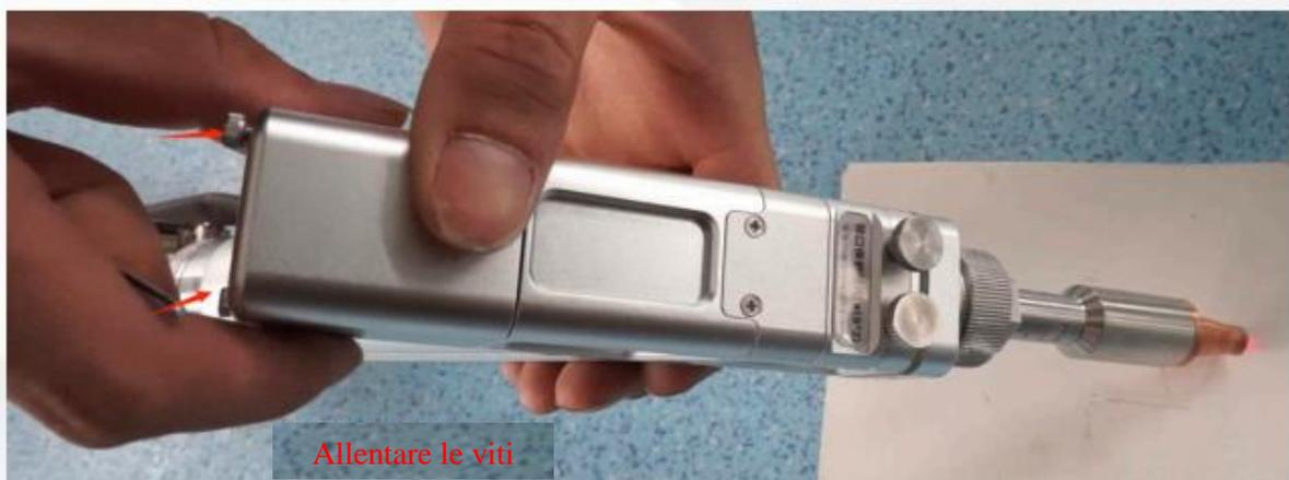
3. La vite C non può essere allentata, diversamente è necessario regolare il motore.
