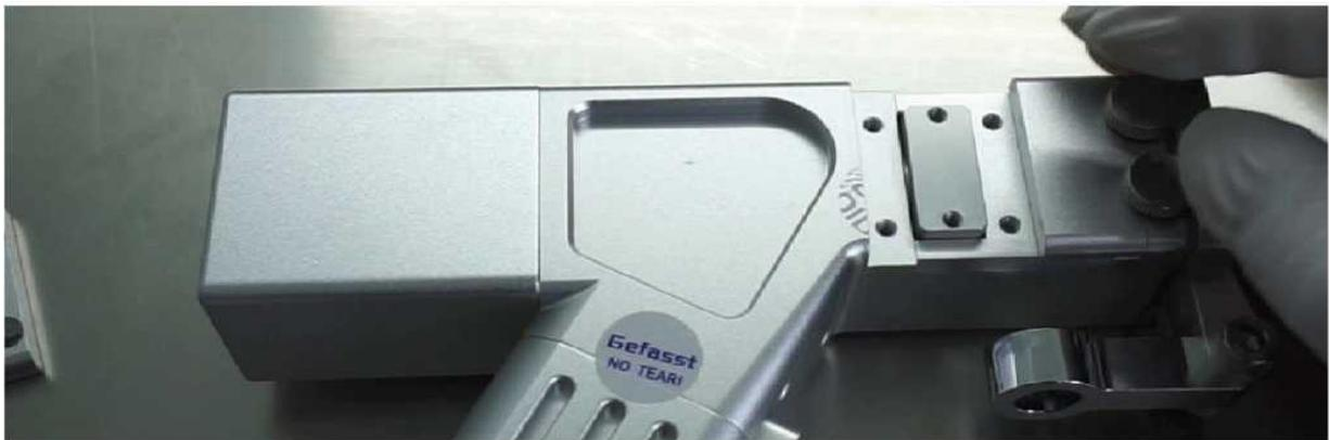
**4.Scheda di circuito:** per verificare se la vite di fissaggio della scheda di circuito è allentato o staccato (vedere la figura).
