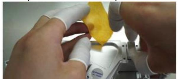
3. Verificare la presenza di macchine nere e polvere sulla lente.
