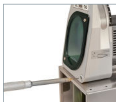
Präzise Längenjustierung der Elektrode.
