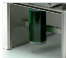
Geschlossener Staubfangbehälter zum Auffangen des Staubes und zur weiteren Entsorgung.
