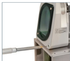
Präzise Längenjustierung der Elektrode.
