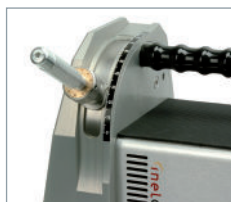
Schleifwinkel von 7,5-90° ermöglichen Spitzwinkel von 15-180°.
