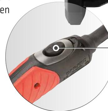
Durch Drücken des Brennerschalters schnell und einfach zwischen 2 voreingestellten Stromwerten wählen - so oft wie nötig.
