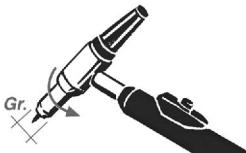
Avvitare bene l'ugello in ceramica il cui diametro interno (Gr.) sarà proporzionale alla corrente di saldatura utilizzata.
