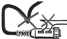
Evitare piegature strette del fascio cavi o dei tubi per non creare strozzature del passaggio del gas o del liquido refrigerante.
