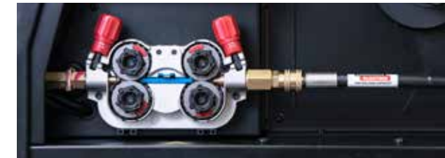
Anschluss für Drahtfässer (optionaler Adapter) Zeitersparnis durch weniger Spulenwechsel
