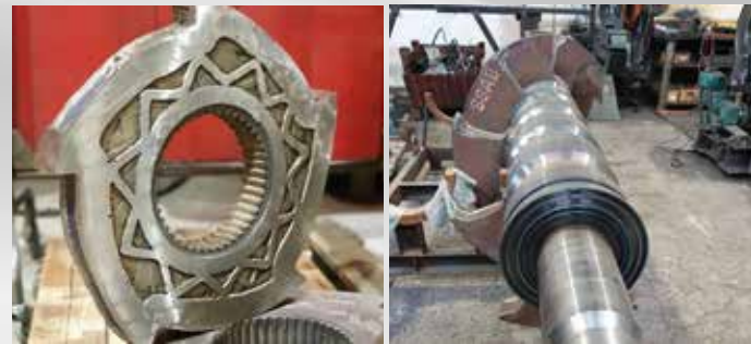
Zerkleinerungsflügel mit Oerlikon Carbofil A600 aufgeschweisst
